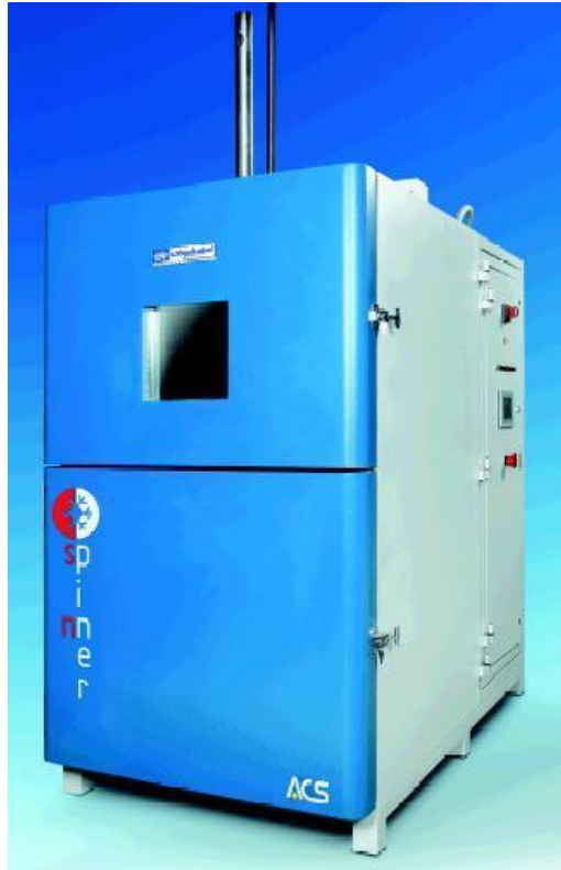
Fig. 2. Angelnatori Spinner thermal shock chamber
