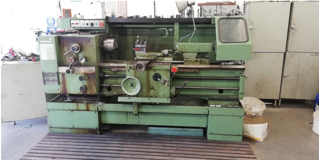
Fig. 4 Metal lathe TOS SUI 40
